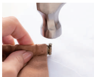
4 輕輕敲擊固定銷，用槌子等工具將其嵌入固定。
